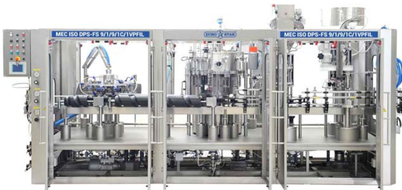
Giostra di riempimento con valvole serie DPS
