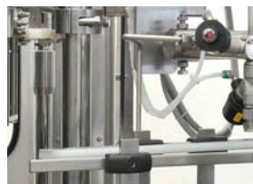
Sistema di gestione in caso di scoppio bottiglia
