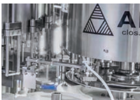
Torretta multiteste di applicazione tappo corona
