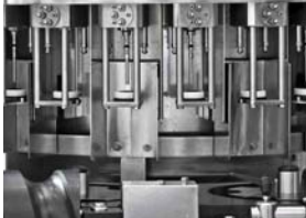
Dettaglio valvole di riempimento serie DPS
