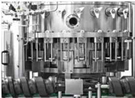
Giostra di riempimento con valvole serie DPS
