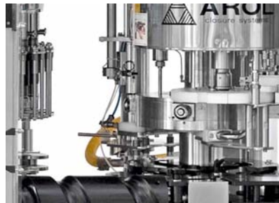
Torretta multiteste per applicazione tappo in sughero
