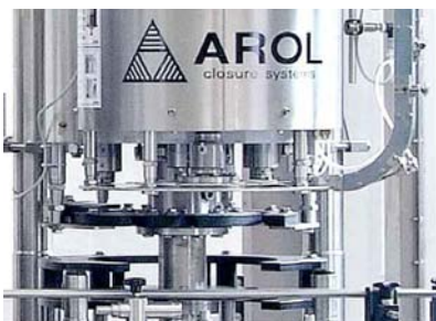
Torretta multitest di applicazione chiusura
