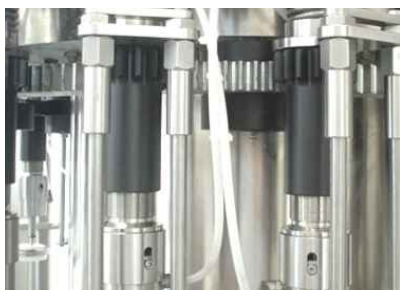
Giostra di riempimento con impostazione centralizzata dei livelli
