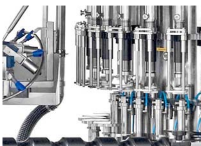
Particolare ingresso giostra di riempimento
