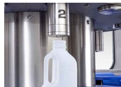
Assenza contatto tra valvola di riempimento e imboccatura
